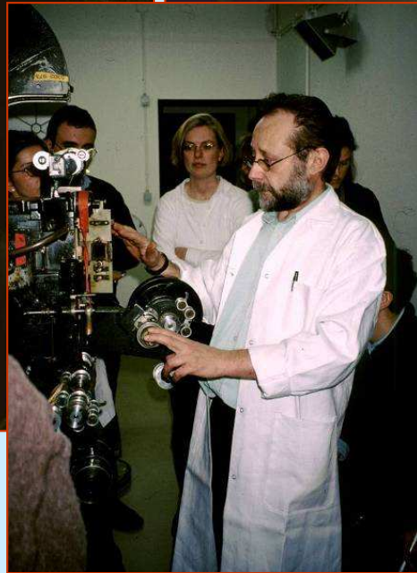
Debrie Matipo, positivadora de contacto, años 30, en condiciones de trabajo .
