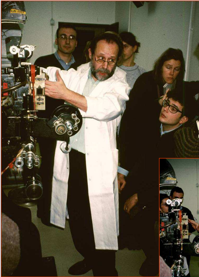
Debrie Matipo, positivadora de contacto, años 30, en condiciones de trabajo .
