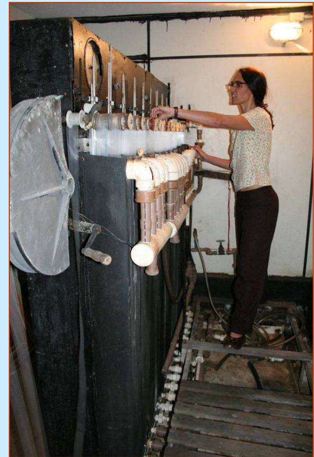
Procesador Debrie de arrastre continuo, ¿finales de los 30? Probablemente único en unas condiciones de trabajo aceptables.
